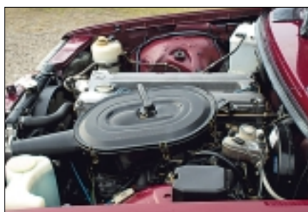
Prachtmotor: DOHC Zescilinder met 185 pk!
